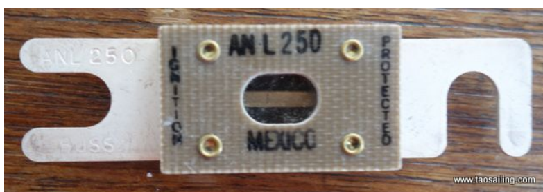
Fusible ANL 250A - capacité de coupure 6kA
